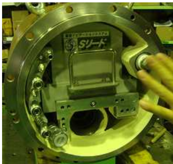
写真.2 Sリード外装管に取り付けた状態
